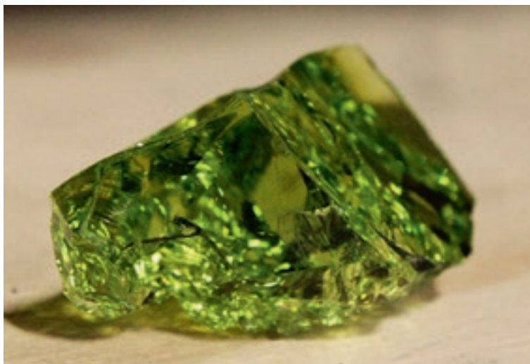
GeoMelt® spracováva jadrový a nebezpečný odpad od 90. rokov minulého storočia a vyrobil vyše 26 tisíc ton skla na uskladnenie.
